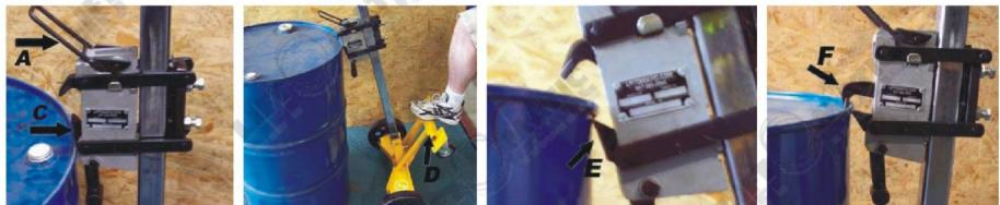
3. 双手握住手把（图号17），脚踩蹬杆（图号27），使其前倾，直至下爪爪尖顶住桶缘下方，同时双手用力下拉，脚向前蹬住蹬杆，使下端的托板紧贴桶臂，直至桶被夹起，根据需要可将桶搬运到任何地方。当桶搬运至目的地时，用脚蹬住蹬杆，双手向前推手把，当上下爪超过桶缘时，夹爪就会自动脱开。
